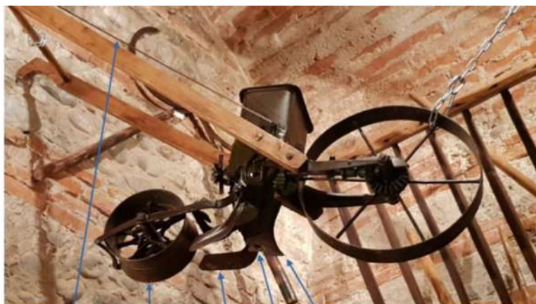
Petit soc Sortie du grain Ailettes refermant le sillon Roue pour retasser la terre Tige régulation débit du grain
